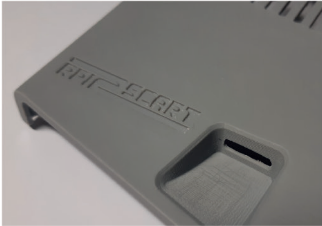
Qualité suffisante (impression à 60 microns à 55mm/s)
