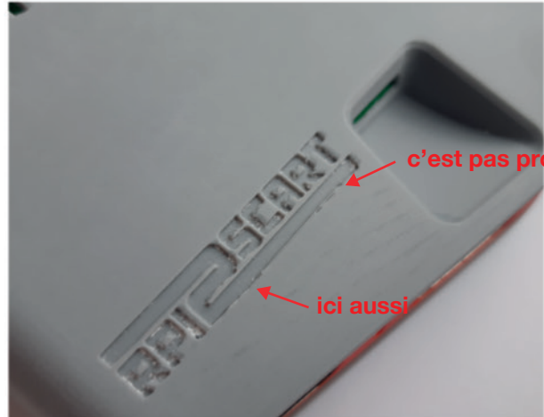
Qualité insuffisante (impression à 70 microns à 65mm/s)
